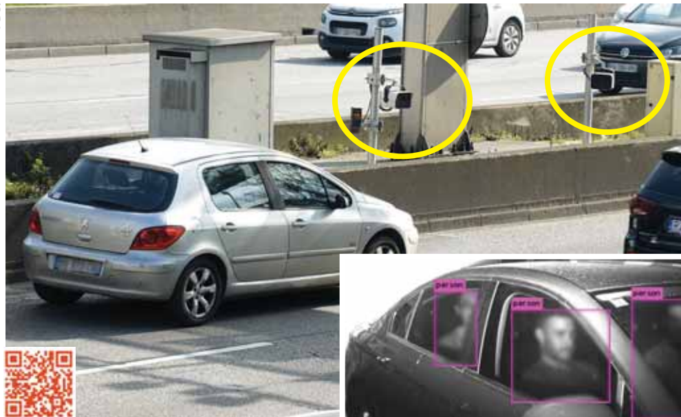
COVOITUS®, une technologie brevetée qui à l'aide de caméras et de l'intelligence artificielle, permet de détecter le covoiturage.
